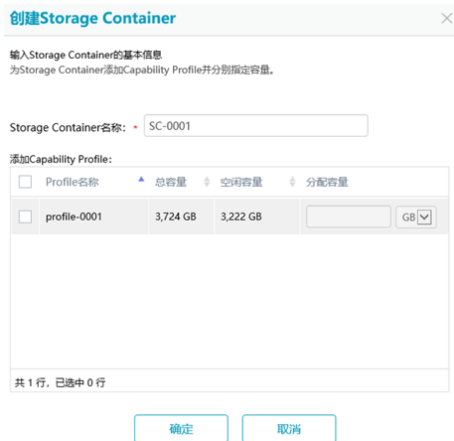
图6-6 创建 Storage Container 界面
